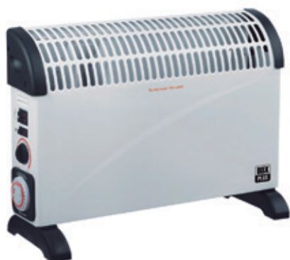
CONVECTOR BOX PLUS 2000W 750/1250/2000W con termostato regulable incorpora un pequeño ventilador interno que distribuye el aire caliente de una forma rápida y silenciosa. Tres funciones de potencia así como una protección contra sobrecalentamiento. Además, posee unas asas para facilitar el desplazamiento y pies de soporte.
