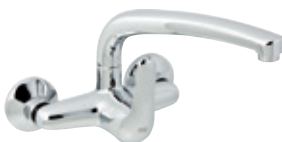
MONOMANDO FREGADERO 143890 Cuerpo realizado en latón según UNE-EN 1982. Maneta realizada en Zamak. Cromado según EN 248. Cartucho cerámico silencioso Ø 40 cm con salida dirigida. Aireador plástico antical M24x1 con casquillo de latón cromado. Suministrado con excéntricas de latón para fijación. 64'95
